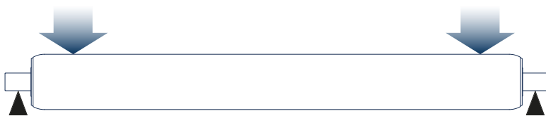
Fig. 3 Carico concentrato alle estremità Load concentrated in the ends
