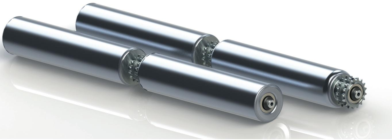
Questi rulli sono comandati dalla catena attraverso il pignone con due corone saldato in posizione centrale ( $R_1=R_2$ ) oppure decentrato ( $R_1 \neq R_2$ ) del tubo. In questi rulli della serie MI2CN, il diametro del rullo è sempre superiore all'ingombro della catena che gli trasmette il moto.
