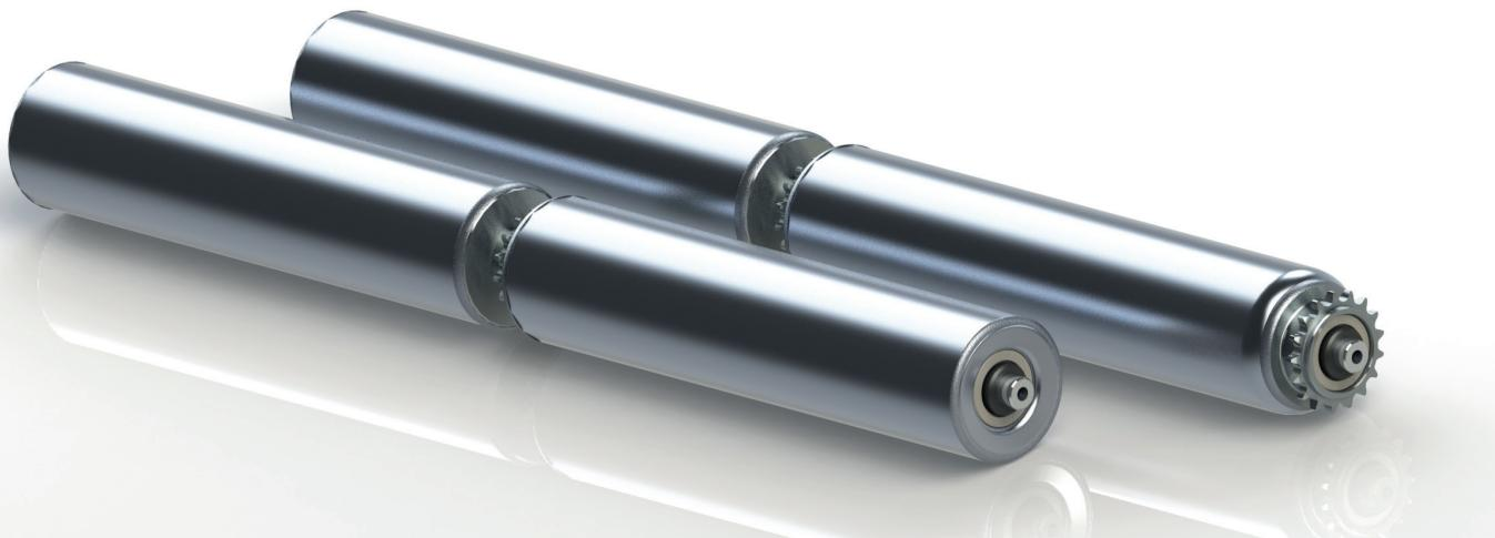
Questi rulli sono comandati dalla catena attraverso il pignone con una corona saldato in posizione centrale ( $R_1=R_2$ ) oppure decentrato ( $R_1 \neq R_2$ ) del tubo. In questi rulli della serie MI1CN, il diametro del rullo è sempre superiore all'ingombro della catena che gli trasmette il moto.
