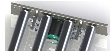
Normalmente sono montati, nella parte inferiore della rulliera, a contatto con due rulli, ad un passo pari alla lunghezza del pallet +50/100 mm.
