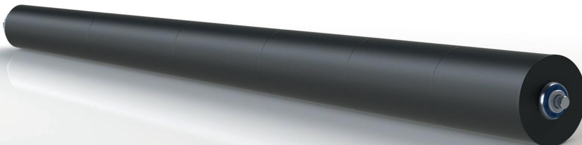
Sono rulli per curve ottenuti calettando dei manicotti troncoconici in PVC su un rullo serie LGE-RS diametro 30 e sono destinati al trasporto di colli leggeri e medio leggeri. La configurazione standard prevede asse con estremità filettate (esec. G) consentendo un semplice e preciso montaggio sulle fiancate forate.
